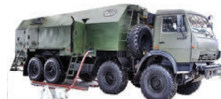
Станция комплексной очистки СКО-10
